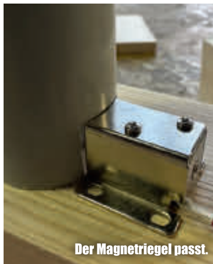
Jetzt können wir den Riegel festschrauben.
