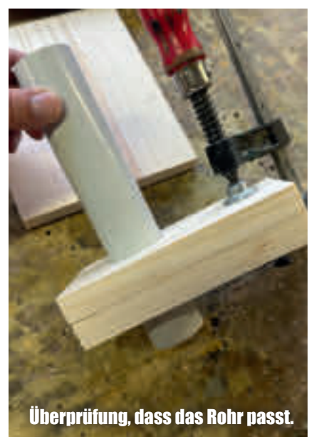
Mit einer Schraubzwinge werden beide Teile arretiert und mit dem Forstnerbohrer durchbohrt.
