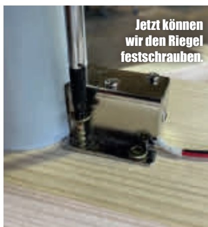
Der Magnetriegel passt.
